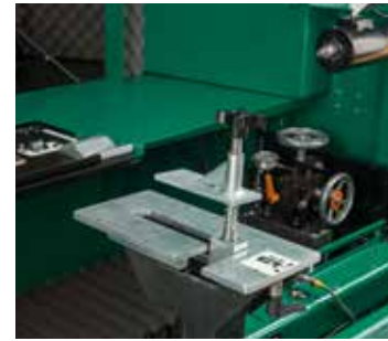
3. KẸP TRƯỚC CÓ BỘ ĐIỀU CHỈNH CHIỀU CAO
