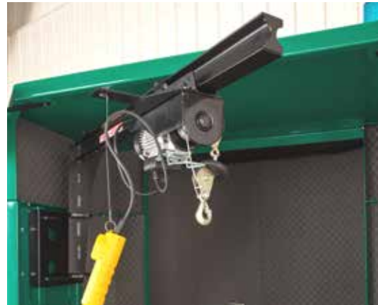
BESTÜCKUNG VON VORN MIT ELEKTRISCHEM AUSLEGER
