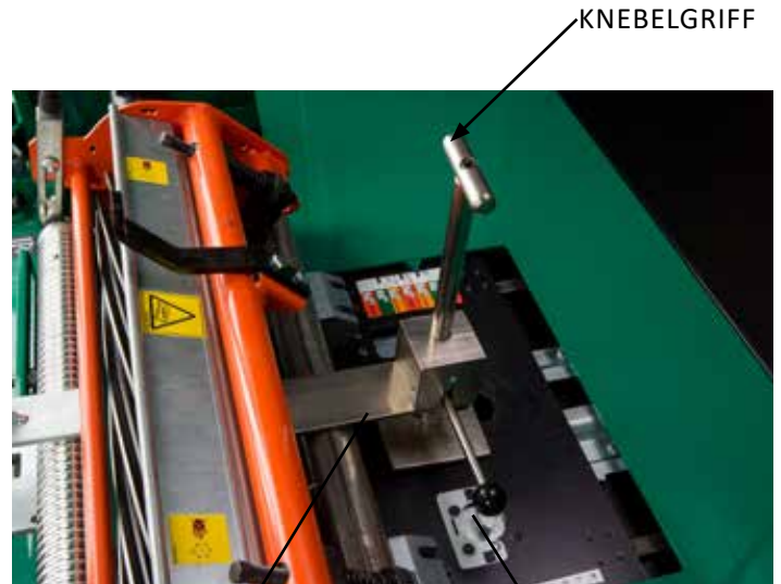
SPANNVORRICHTUNG HINTERE WALZE Abb. 32 VERRIEGELUNGSKNAUF
