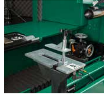
3. VORDERE SPANNVORRICHTUNG MIT HÖHENJUSTIEREINRICHTUNG
