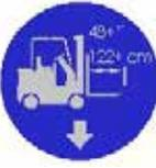
Utiliser un chariot élévateur doté de fourches d'au moins 122 cm [48"] de long pour déplacer cet équipement. Pour soulever la machine, la saisir uniquement par les parties indiquées. L'utilisation d'un élévateur non adapté peut occasionner des blessures corporelles ou endommager l'équipement.
