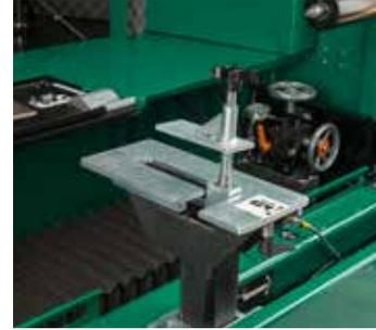
3. BRIDE DE FIXATION AVANT AVEC RÉGLAGE EN HAUTEUR
