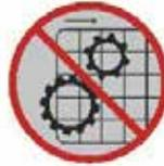
AVERTISSEMENT : ne jamais retirer les dispositifs de protection de cet équipement avant de l'utiliser. Ils protègent des pièces en mouvement.
