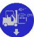
Utiliser un chariot élévateur doté de fourches d'au moins 122 cm [48"] de long pour déplacer cet équipement. Pour soulever la machine, la saisir uniquement par les parties indiquées. L'utilisation d'un élévateur non adapté peut occasionner des blessures corporelles ou endommager l'équipement.
