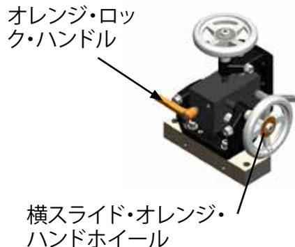
カッピング・ユニットを水平に配置するには、ACCU - ポジショニング・ゲージを上方のピンに置きます。横スライド上のオレンジ・ロック・ハンドルのロックをはずします。
