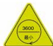
研磨ホイールの定格として最小速度 [3600 RPM]を表示し、本装置で使います。
