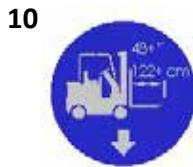
この装置を移動するには、最小48" [122cm] の長さのフォークを持つフォークリフトを使ってください。リフトは本機に示されたところでのみ行ってください。適切なリフト用の装置を使わないと、個人の障害または装置への損傷を引き起こす場合があります。
