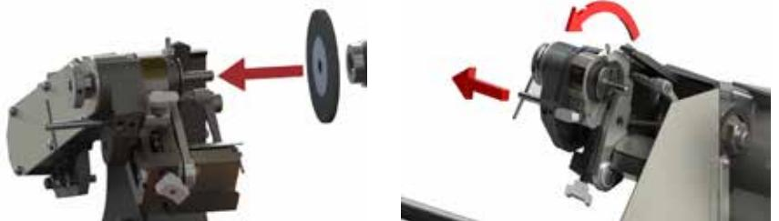
左側のプランジャー・ピンを引き、フィンガーと本体アセンブリを左側のプランジャー・ピンがロックされる位置まで(右側からみて反時計回りに)リリーフの位置に回します。注意: プランジャー・ピンは、適切な機能を得るためにリリーフ調整器ノブに差し込まれていなければなりません。
