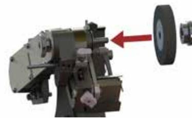
注意: 固定フィンガーを上下するためにロック・ハンドルのロックをはずし、研磨ホイールの摩耗に合わせます。
