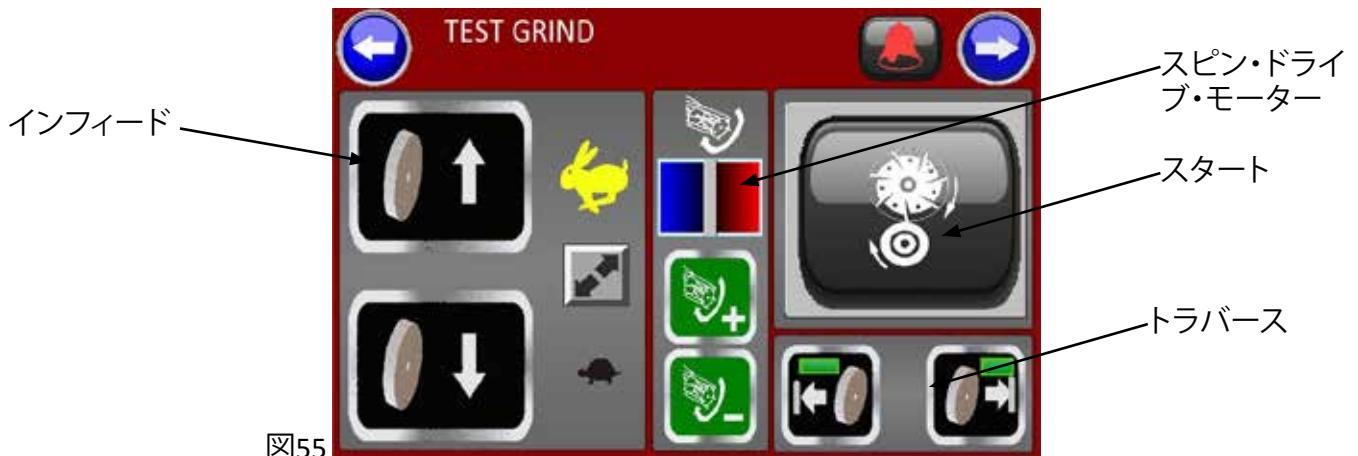
1. ドアを閉じます(研磨ホイール・モーターおよびスピンドライブはドアが開いた状態では動作しません)。
