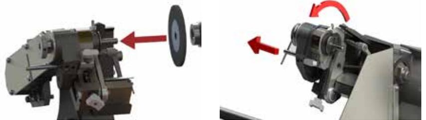
左側のプランジャー・ピンを引き、フィンガーと本体アセンブリを左側のプランジャー・ピンがロックされる位置まで(右側からみて反時計回りに)リリースの位置に回します。注意: プランジャー・ピンは、適切な機能を得るためにリリース調整器ノブに差し込まれていなければなりません。
