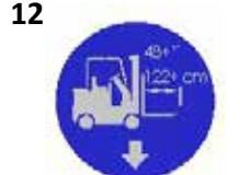
この装置を移動するには、最小48" [122cm] の長さのフォークを持つフォークリフトを使ってください。リフトは本機に示されたところでのみ行ってください。適切なリフト用の装置を使わないと、個人の障害または装置への損傷を引き起こす場合があります。
