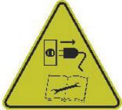
Lea el manual de mantenimiento y desconecte la alimentación antes de realizar reparaciones.
