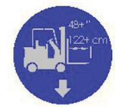
Utilice una carretilla elevadora con horquillas de 122 cm [48 pulg.] de longitud como mínimo para mover este equipo. Eleve únicamente donde está indicado en la máquina. La no utilización de un equipo de elevación adecuado puede provocar lesiones personales o daños en el equipo.
