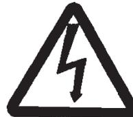
Symbol für die Kennzeichnung von Blenden, Abdeckungen oder Bereichen, hinter bzw. in denen sich stromführende Komponenten befinden.
