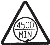
Achtungssymbol für die Motordrehzahl und die Drehzahl der Schleifscheibe mit minimaler Sicherheitsklassifizierung.
