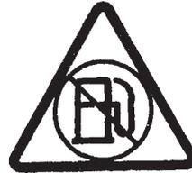
Symbol mit dem Hinweis, ungeschütztes Benzin oder brennbare Materialien von der Schleifmaschine fernzuhalten, da während des Betriebs viele Funken erzeugt werden.
