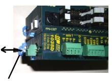
PRY OUT ON LARGE BLUE TAB THAT HOLD THE STEPPER CONTROLLER TO THE DIN RAIL
