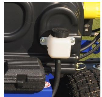
RÉSERVOIR DE PONT TRANSMISSION
